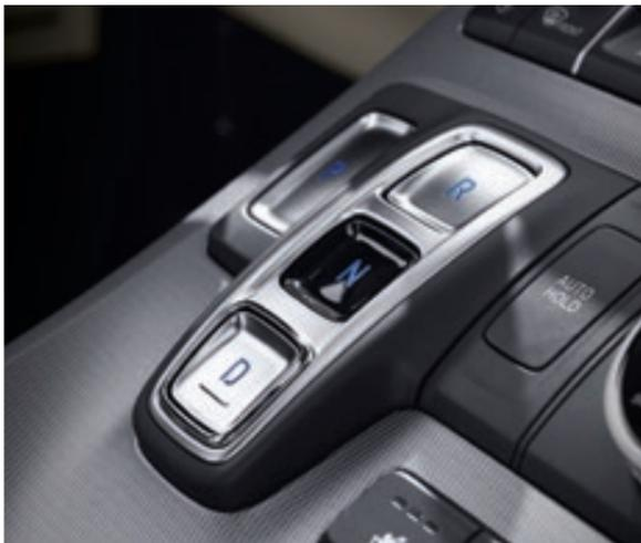
Переключение режимов 8-ступенчатой автоматической коробки передач кнопками
